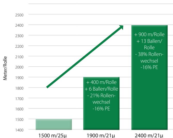
Basierend auf: 1,20er Rundballen, 6 Lagen Folie, 55 % Überlappung, 70 % Vordehnung, im Vergleich zu 1500 m/25µm Folie.
