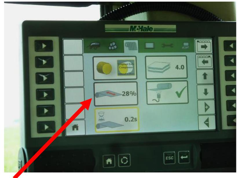
Die Vordehnung muss maschinenseitig auf das neue Produkt angepasst werden
